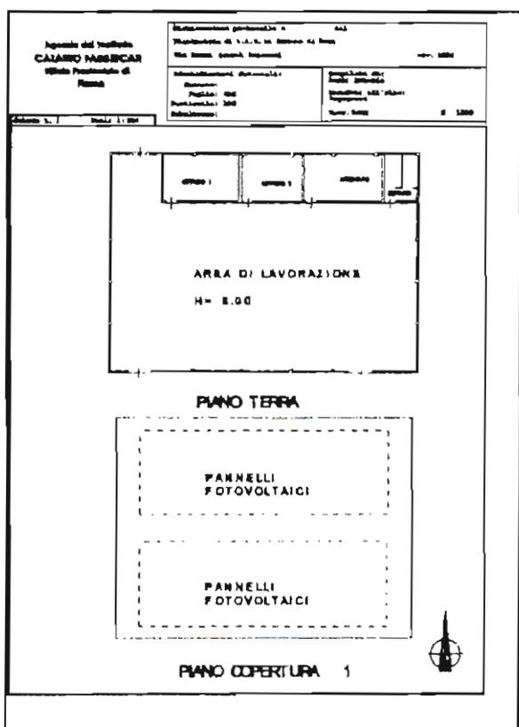
*Esempio di rappresentazione in planimetria di impianto fotovoltaico realizzato sulla copertura di un edificio.*
